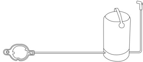
Der Wasserbeutel wurde primär für den Camping-Einbau Nestbox Tramp entworfen, man kann ihn aber auch selbstständig benutzen. Er fasst 12 Liter Wasser und die Druckdusche dient zur Grundhygiene, zum Abspülen von verschmutzten Gegenständen oder zum Gerschirrspülen. Sein Vorteil ist, dass man bei der Nutzung keinen elektrischen Strom braucht und die Dusche nicht hochhängen muss. Dank der Pumpe ist Wasser unter Druck, auch wenn der Beutel auf dem Boden steht oder im Camping-Einbau eingeschoben ist.
