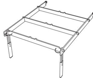
Dieser Set unterstützt den Rost unabhängig von den Rücksitzen. Mit der universellen Rostunterstützung wird standardmäßig auch ein Beutel geliefert, in dem der ganze Set sicher aufbewahrt wird.
