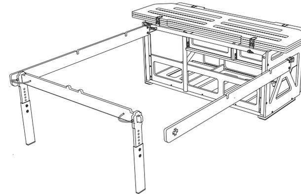
Die zwei Längsrippen C mit Hilfe der zwei Querrippen D verbinden
