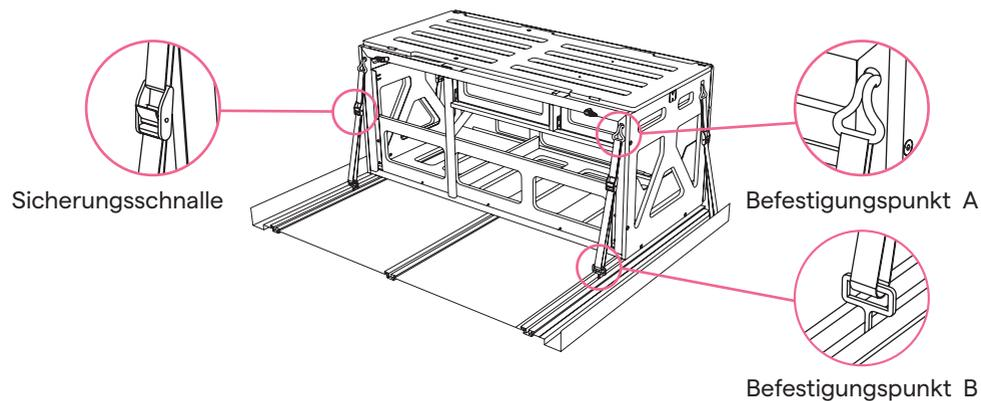
**Seitlicher Teil des Autoeinbaus Nestbox:** befinden sich die Befestigungsösen in Ihrem Fahrzeug seitlich des Autoeinbaus? Falls ja, gehen Sie wie folgt vor.
