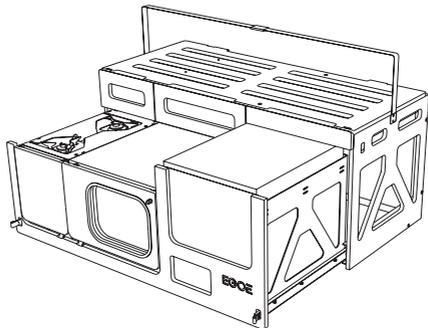
Die Hauptschublade arretiert in der eingeschobenen und ausgezogenen Position und wir lösen sie immer durch leichten Zug nach oben an den beiden Schlaufen, die sich jeweils an der Unterseite der Schublade befinden.
