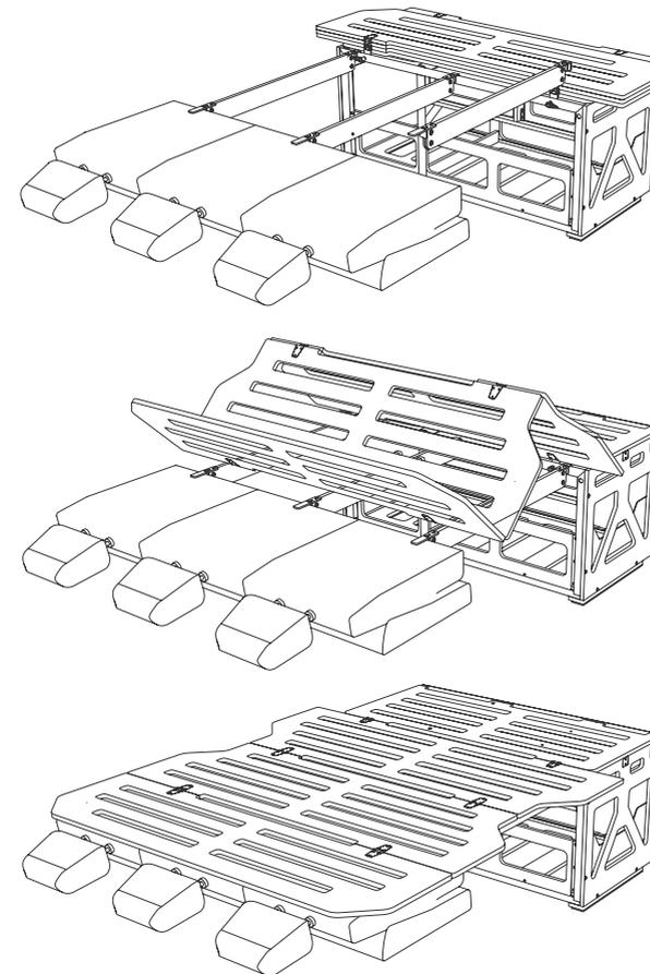
**Mit Hilfe der Stützrippen und fixiert mit Hilfe von auf die Kopfstützen der Rücksitze aufgesetzten Stabilisationselementen:** ziehen Sie die Kopfstützen der Rücksitze heraus und schieben Sie anschließend die Stabilisationselemente der Stützrippen darauf, die wir an den Seiten noch mit Hilfe von Holzstiften fixieren, welche ein unerwünschtes Herausrutschen verhindern.
