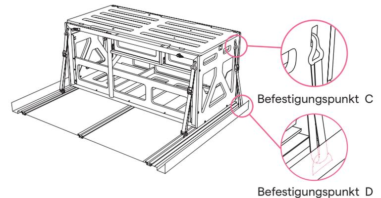
**Vorderer Teil des Autoeinbaus Nestbox:** falls sich die Befestigungspunkte Ihres Fahrzeugs im hinteren Bereich des Fahrzeugs unterhalb der eingesetzten Nestbox befinden, befolgen Sie die folgenden Anweisungen.
