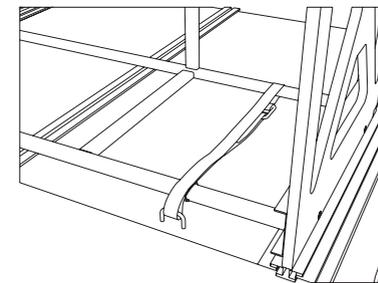
Nun können die Module in den ordentlich verankerten Autoeinbau eingesetzt werden und zwar, indem die untere Hauptschublade des Autoeinbaus herausgezogen und arretiert und links beginnend (bei Blick auf den Einbau) nacheinander das Kocher-Modul, das Wasser-Modul und der Kühlschrank eingesetzt wird.
