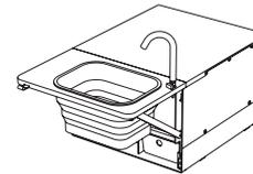
Das Wasser-Modul ist Bestandteil des Küchensets und dient der Essenzubereitung oder der Grundhygiene. Das Modul wird durch einfaches Einlegen in die Hauptschublade des verankerten Nestbox-Autoeinbaus eingesetzt. Das Modul besteht aus einer Aluminiumkonstruktion und Birkenesperrholz mit HPL-Oberfläche. Die Bedienung erfolgt mit Hilfe eines Wasserhahns.
