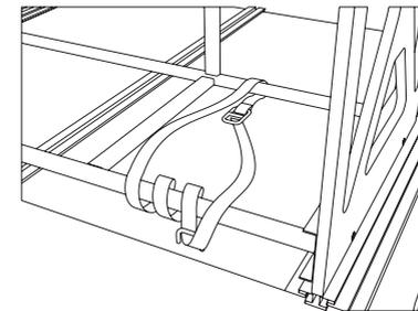
Das freie Gurtende durch die Schnalle ziehen, dadurch wird der gesamte Gurt gespannt und durch die Schnalle gesichert. Dasselbe Vorgehen wiederholen wir auf der gegenüberliegenden Seite.
